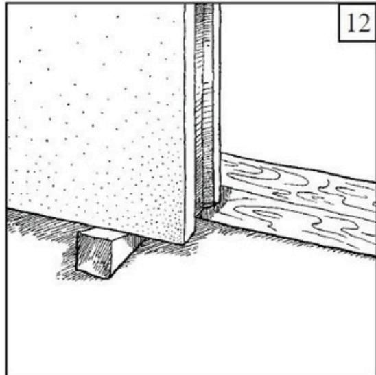
11. As paredes devem ser empurradas contra as paredes anteriores (e movidas para cima e para baixo) de modo que a lingueta e a ranhura fiquem cuidadosamente posicionadas uma contra a outra e o agente de colagem seja espremido para fora. A espessura correta da junta entre dois painéis é de 1-2 mm.
