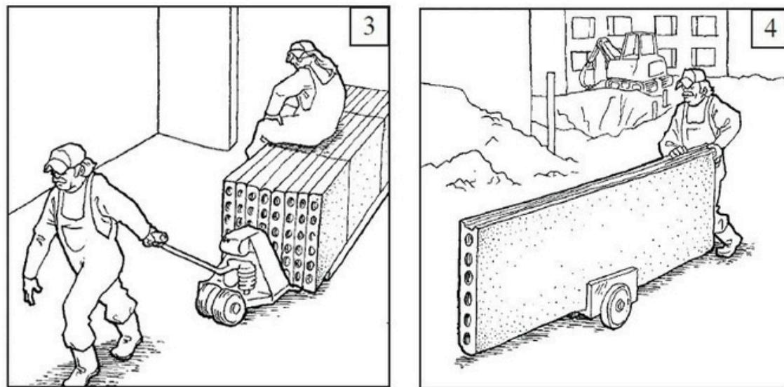
3. As pilhas de painéis de parede podem ser facilmente movidas no canteiro de obras por uma empilhadeira ou carrinho.
